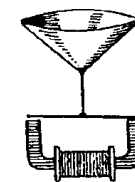
FIG. 98 (à gauche). — Coupe d'un haut-parleur électromagnétique à pavillon.
